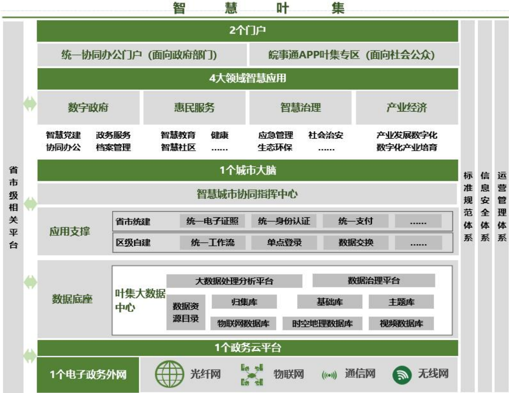
图 3-1 叶集区新型智慧城市总体架构
